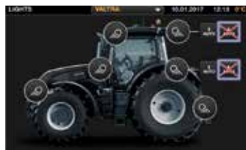
Terminale lengva konfigūruoti darbinius žibintus. Darbinių žibintų įjungimo / išjungimo jungikliai ir švyturėlių įjungimo / išjungimo jungikliai yra porankyje.
